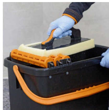
Det är viktigt att tvättvattnet byts med jämna mellanrum (5 - 10 m 2 ). Tvättvattnet ska hållas i ett separat kärl för sedimentering och inte direkt i avloppssystemet.
